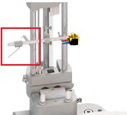
Abb. 21: Befestigen der Gegengewichte
