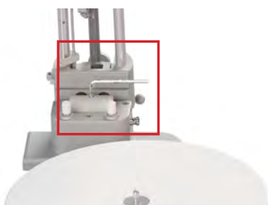
Abb. 12: Sichern des Tonarmes
