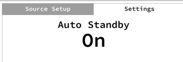
La función de modo de espera automático está integrada en el C 368 y cumple con los reglamentos europeos de diseño ecológico. Se puede configurar el C 368 para que pase automáticamente al modo en espera si no hay ninguna interacción en la interfaz del usuario ni una entrada de fuente activa por 20 minutos.
