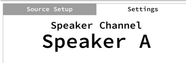
La función SPEAKER CHANNEL le permite activar o desactivar los altavoces conectados respectivamente a las terminales SPEAKERS A y SPEAKERS B del panel posterior.
