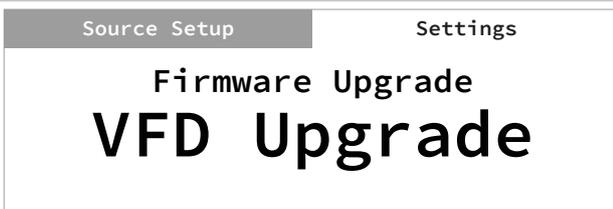
Seleccione la actualización del firmware para iniciar la actualización de la VFD o del BT. En cada modo de actualización, seleccione "Yes" (sí) para iniciar el proceso de actualización o "No" para conservar el firmware actual.
