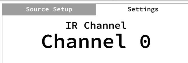
El C 368 puede operar por medio del canal infrarrojo alternativo (IR Channel). Esto es útil si tiene dos productos NAD que se pueden controlar con comandos similares del mando a distancia. Con la función IR Channel, se puede controlar independientemente dos productos NAD distintos en la misma zona configurando cada uno en un canal infrarrojo distinto.
