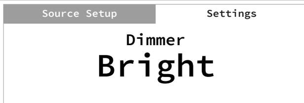
La función de atenuación Dimmer permite ajustar la luminosidad de la pantalla del panel delantero.
