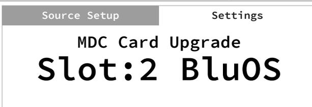
El menú de actualización de la tarjeta de MDC identifica y muestra los módulos MDC instalados en las ranuras de MDC del panel posterior.
