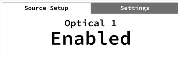
Esta opción permite activar o desactivar una fuente. Es especialmente útil si solo se utilizan pocas fuentes y se selecciona directamente la fuente en el panel delantero, omitiendo las fuentes que no se usan.
