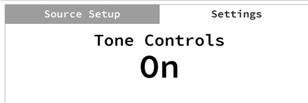
Los controles de tonos permiten reforzar o reducir frecuencias de audio particulares. Los niveles de control de tonos, graves y agudos se pueden encender y apagar.
